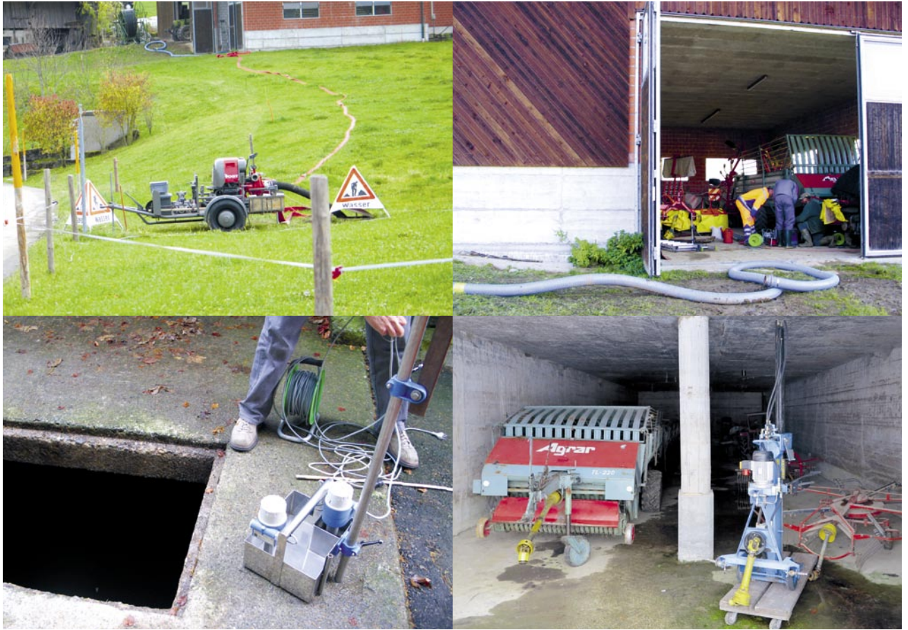
Obere Bildreihe: Der Feuerwehrschauch in anderen Diensten: Durch Umpumpen von einem Betrieb zum andern wird das Wasser für die Prüfung wieder verwertet. Unten links: Installation des Wasserstandsmessgeräts. Unten rechts: Jauchegrube – als Gerätelager (um-)genutzt.
